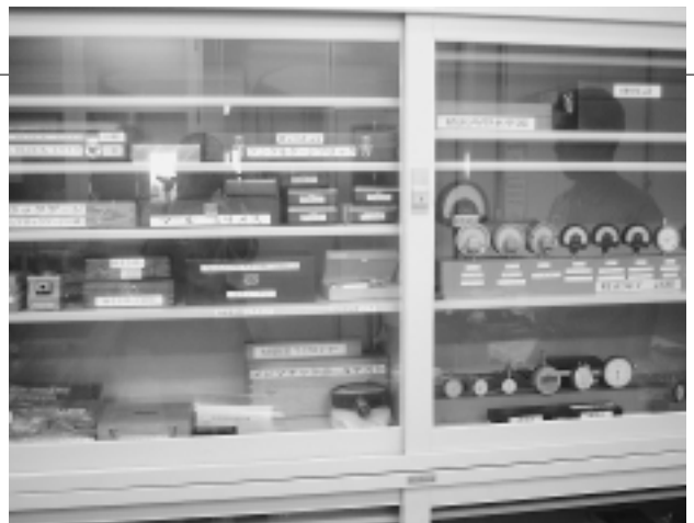
ずらりと並べられたゲージ：取引先の仕様と合わせるため各種のゲージを取り揃えている
