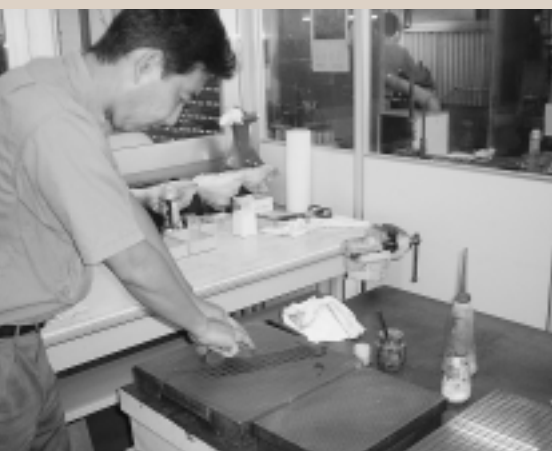
研磨作業：左の金属板から順番に荒削り 中仕上げ 仕上げの3工程を繰り返す磨き上げられると研磨した面が鏡のような輝きが出る
