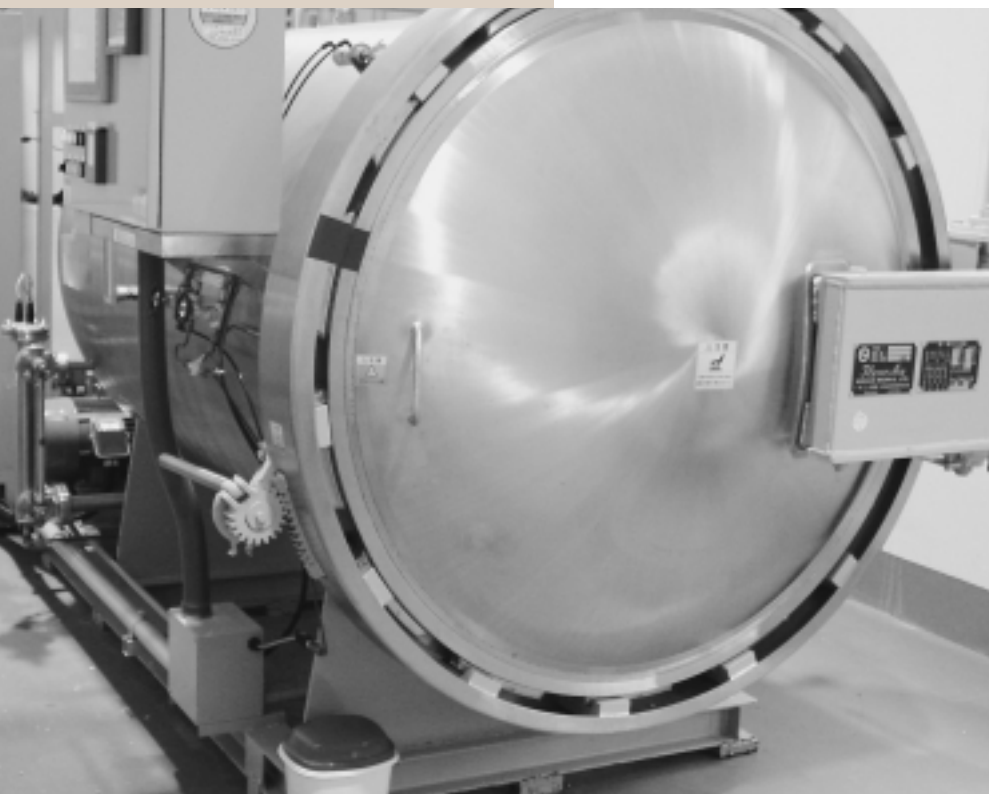
加熱処理機：真空パックした素を一定の時間・温度で加熱消毒する 同社の機械では一度に2パレット(1パレット：18バック×18段)処理可能
